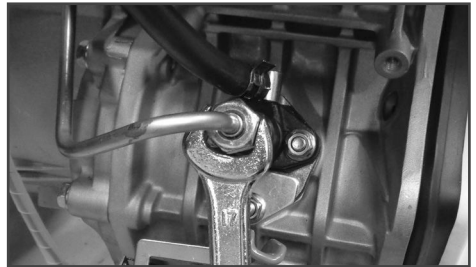
Рис. 12 Удаление воздуха из топливного насоса
